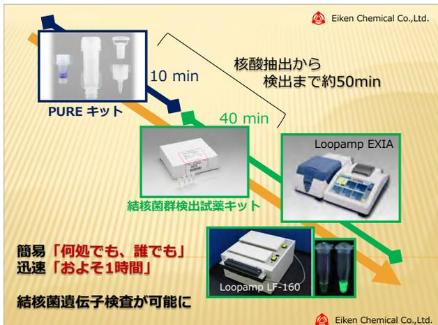
全体の流れですが、検体の前処理を行う PURE キット、増幅から検出を乾燥された増幅試薬セットを使用します。増幅試薬セットは2種類ありまして、途上国向けには構造が非常にシンプルな Loopamp LF-160、国内向けにはリアルタイムに計測できる装置を開発しております。DNA 抽出は 10 分間ででき、増幅には 40 分間かかりまして、検出自体は見るだけで済みますので全体として合計 50 分で結果が得られます。以上の操作には遠心機やマイクロピペットは一切使用しません。すべての試薬は室温で保存が可能です。特別な設備がなくても実施できることを実現しています。
