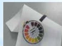
漆喰塗料アレスシッコイの主成分は、**消石灰**（水酸化カルシウム： $\text{Ca}(\text{OH})_2$ ）で、その塗膜は強アルカリ性を示し、殺菌効果が高く良好な抗菌性を有する。
