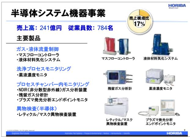
今回はまったく関係ありませんが、マスフローコントローラという、ガス・液体流量制御装置もあります。半導体を製造する時に色々なガスを使うのですが、その流量を制御したり、薬液を入れたりするものです。半導体の異物をテストするような装置も出させていただいています。
