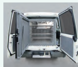
ワクチン専用冷蔵庫を積載した車内
